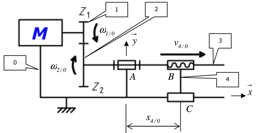
a) Le schéma a été décomposé ; placer le nom et le numéro des composants (le bâti (0), la roue (1), la roue (2), la vis (3), l'ensemble (2+3) et l'écrou (4)).
