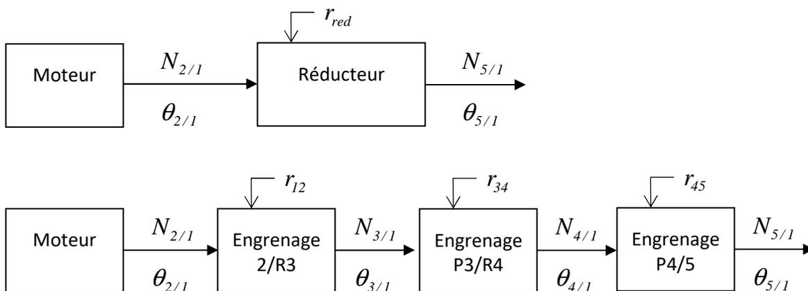
b) Calculer les rapports de transmission  $r_{2-R3}$ ,  $r_{P3-R4}$  et  $r_{P4-5}$ .
