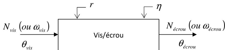
b) Etablir la loi d'entrée/sortie cinématique (en  $\text{tr} \cdot \text{min}^{-1}$  et  $\text{m} \cdot \text{s}^{-1}$ ).
